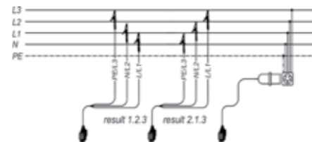
Schaltung für Spannungsmessungen, Frequenz und Phasenfolge
