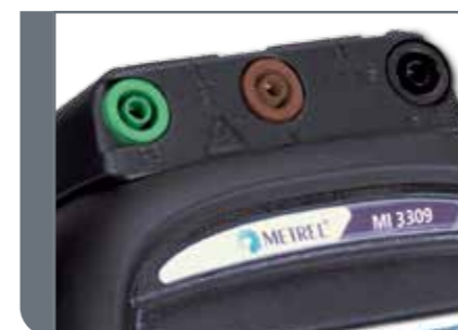
Eingabe für die Prüfung fest installierter Geräte.
