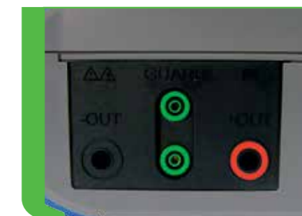
Ableitklemme zum Anschluss geschirmter Prüflleitungen
