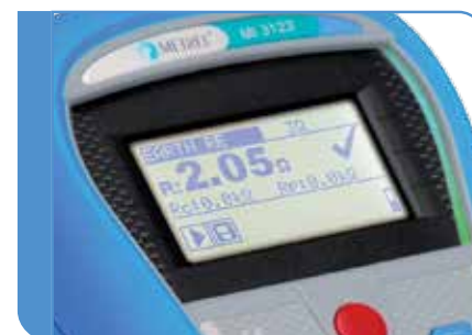
Große LCD-Anzeige mit Hintergrundbeleuchtung und PASS/FAIL-Ausgabe.
