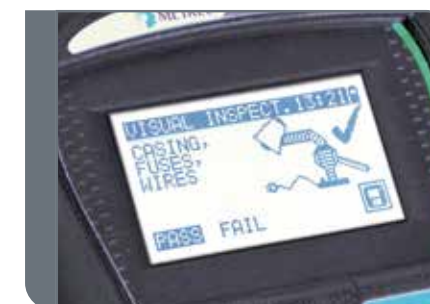
Große LCD-Anzeige mit Hintergrundbeleuchtung und PASS/FAIL-Ausgabe.
