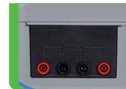
Prüfleitungsanschluss mit vier Bananensteckern.
