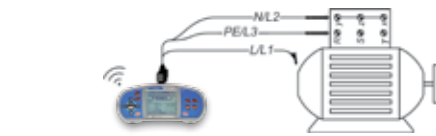
Prüfstromkreis für die fortlaufende Widerstandsmessung
