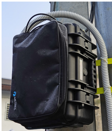
Strommast mit Outdoorcase und MI 2892 PowerMaste
