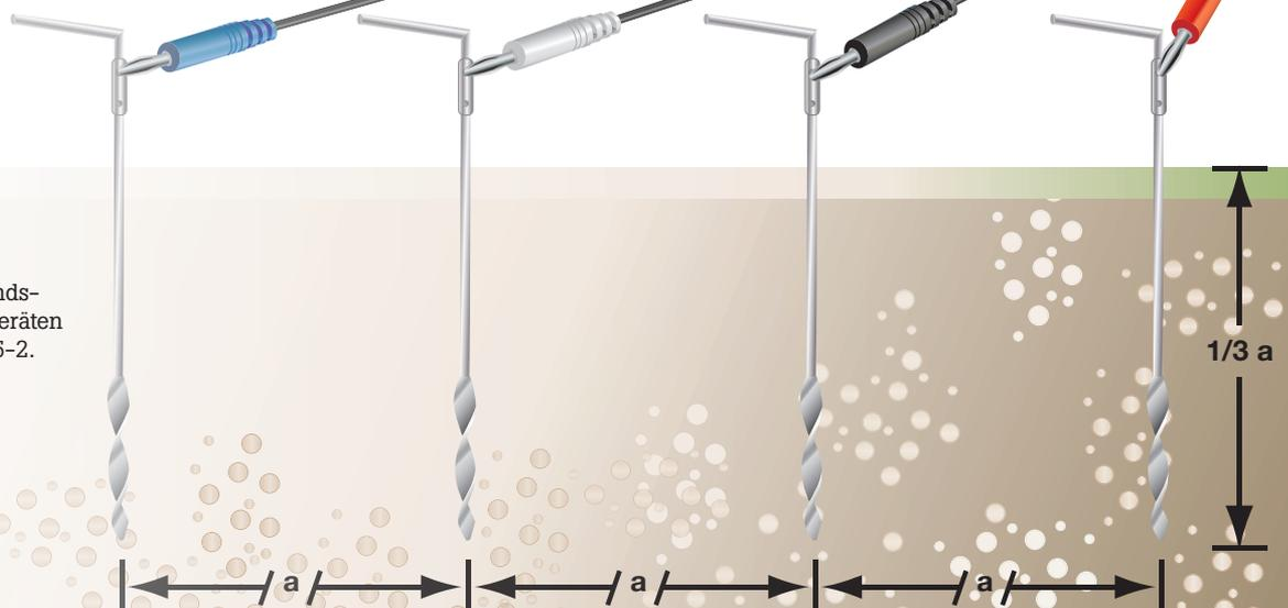
Aufbau zur Erdwiderstandsmessung mit den Messgeräten Fluke 1623-2 oder 1625-2.
